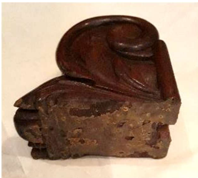
Rester av gammalt PVAc-lim på en av volutens fogtytor
