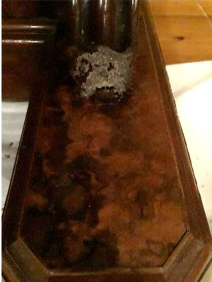
Lim har avlägsnats på pianots fotstycke, uppsvällt och vitnat lim återstår på konsolens fogyta.
