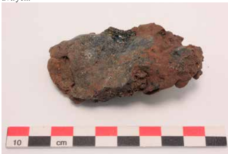
Figur 1. Slagg F8108 med smälta ytor av lera som framträder som gråa, glasiga skikt.
