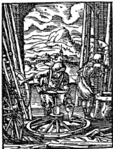
1500-talsbild av en hjulmakare i sin verkstad i färd med att borra ut navet till ett hjul. Hans medhjälpare står vid huggkubben och hugger till en spjåla till vagnssidan. Liknande verktyg finns i verkstaden i Skintebo.
