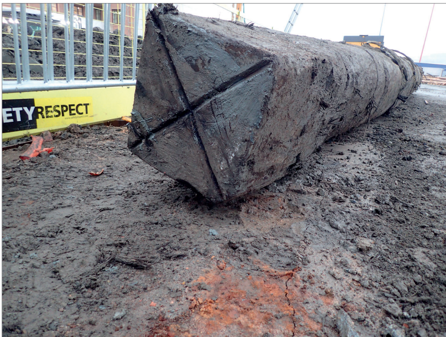
Figur 23. Bottendel till undermast 566. Den bestod av ett ektrimmer vars nedre del bearbetats till kvadratisk form. På undersidan fanns skårar för att kunna låsa fast den i skrovet. I bakre delen av bilden syns även två av de järnband som mer jämna mellanrum satt fästa runt masten. Foto: Astrid Lennblad, Bohusläns museum.
