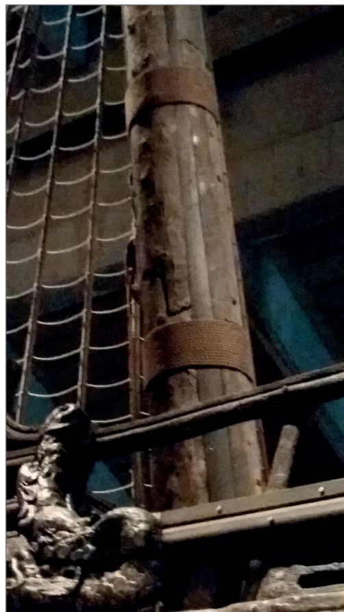
Figur 28. Skeppet Vasas stormast. Som syns på bilden har Vasas stormast en liknande konstruktion som de master som påträffats vid denna undersökning. Foto: Astrid Lennblad, Bohusläns museum.
